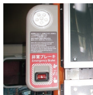
緊急停止ボタン
